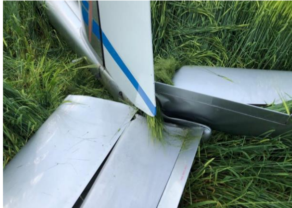
Obrázek č. 2 Poškození VOP a koncové části trupu kluzáku L 13 A Blaník po přistání do terénu.
